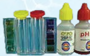
■ Testkit: Bộ thử nước Xuất xứ: Pentair – USA Đo nồng độ Clo và pH trong nước hồ bơi.
